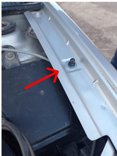
Открутить болт крепления крыла и вкрутить в штатное место болт - шарнир М6 с шайбой М6
