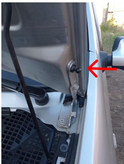
Открутить верхний болт крепления крышки капота и вкрутить в штатное место болт шарнир М6 с шайбой М6
