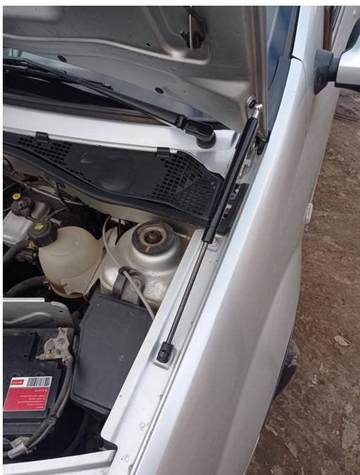
Установить упор, защёлкнув фитинги на шарниры (для установки металлического шара на шарнир, отстегните “серьгу” застёжку, выньте её, далее наденьте шар на шарнир и вставьте застёжку обратно).
