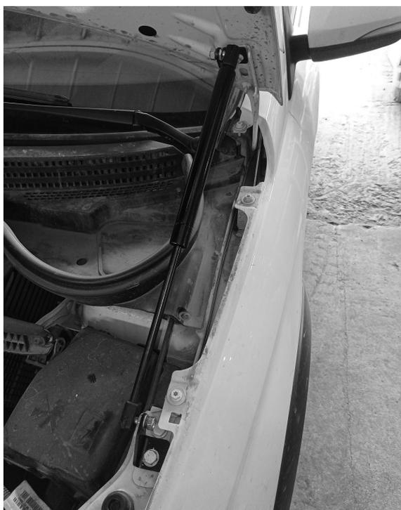
Установить упор, защёлкнув фитинги на шарниры, **ОБЯЗАТЕЛЬНО** штоком (узкая часть) вниз.
