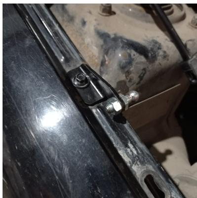
Открутить болт крепления крыла и установить кронштейн крыла в сборе с болтом - шарниром и гайкой, как показано на фото; зафиксировать кронштейн болтом.
