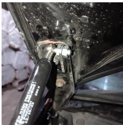
Открутить верхний болт крепления крышки капота. Установить кронштейн в сборе болтом - шарниром и гайкой как показано на фото, зафиксировать кронштейн болтом.
