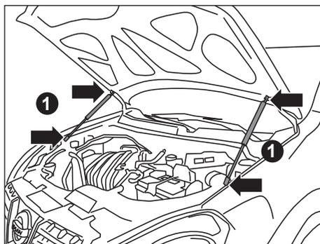
Повторите шаги 1-5 для установки элементов с правой стороны автомобиля. Приподнимите капот, придерживая его одной рукой и уберите на свое место штатный упор капота. Убедитесь, что установка упоров проведена в соответствии с инструкцией, затем аккуратно закройте капот.
