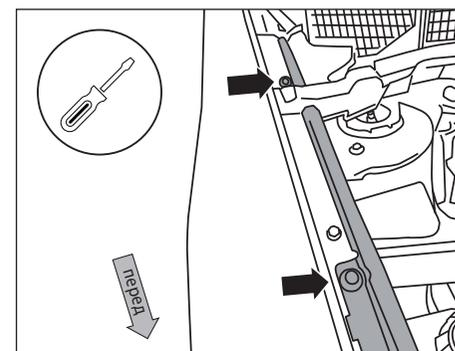
С помощью отвертки с плоским жалом удалите пистоны и снимите пластиковую панель на левой стороне автомобиля (со стороны пассажира).
