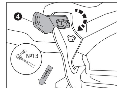
Открутите верхнюю гайку крепления капота. Установите левый кронштейн капота (2), сместить его в крайнее левое положение, соориентировав вдоль ребра жесткости капота. Зафиксируйте штатной гайкой.
