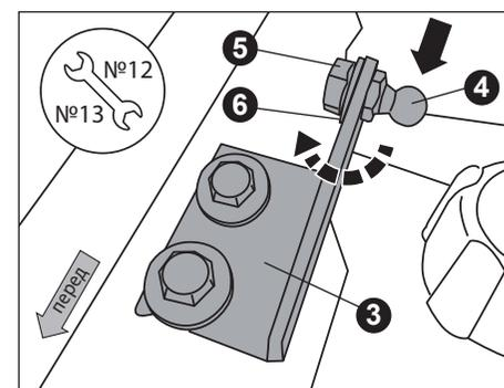
Смонтируйте шаровый болт М8 (4) на кронштейн (3), закрепив гайкой М8 (5) с шайбой Ø8 (6) используя ключи №12 и №13.
