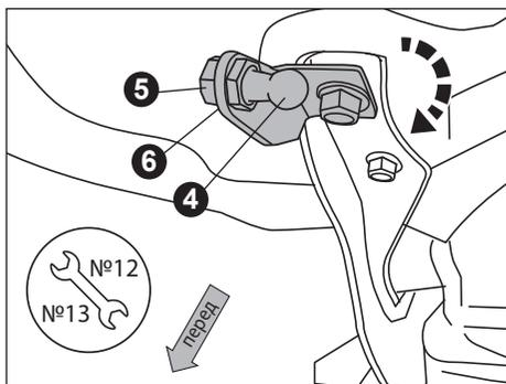
Смонтируйте шаровый болт М8 (4) на кронштейн капота, закрепив гайкой М8 (5) с шайбой Ø8 (6) используя ключи №12 и №13.
