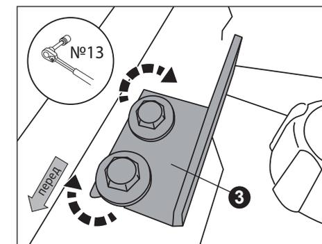
Торцевой головкой №13 открутите полностью верхний болт и частично нижний болт крепления рамки радиатора. Подведите кронштейн крыла (3) под нижний болт крепления рамки радиатора и зафиксируйте его верхним и нижним штатным болтом.
